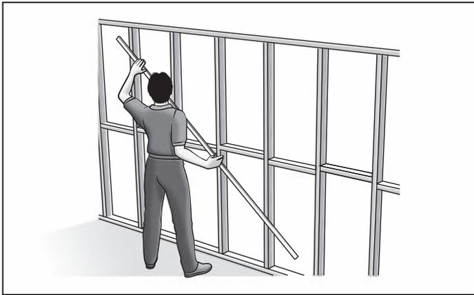
**FIGURE 1 FRAME STRAIGHTNESS**
